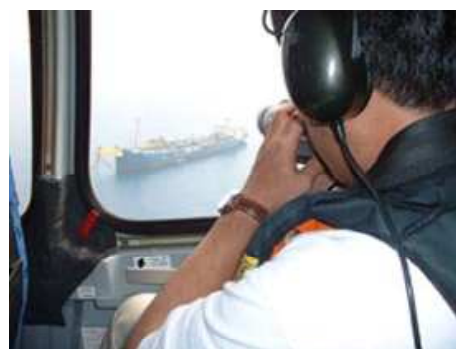
タンカーを改造した FPSO-RD 1 (貯蔵量 80 万バレル)
